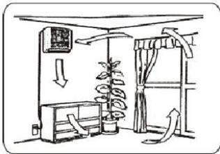
**Hängend:** Stellen Sie sicher, dass die Wand, an welcher Sie das Gerät befestigen, ausreichend stabil ist. Wählen Sie einen geeigneten Platz aus und montieren Sie das Gerät mit der Oberseite nach unten.
