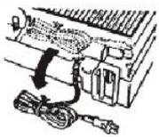
2. Nehmen Sie die im Gerät befindliche Zuleitung und führen sie durch die dafür vorgesehene Aussparung im Boden des Gerätes nach draußen.
